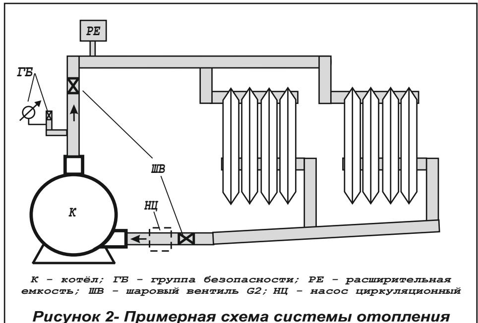
**Рисунок 2- Примерная схема системы отопления**
