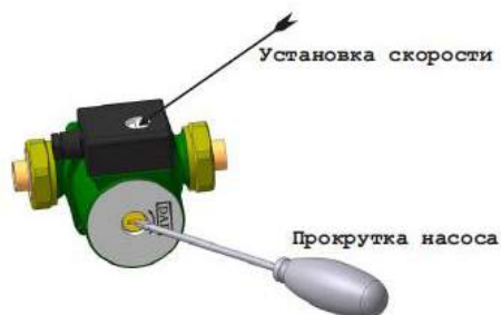
Рис. 23 Схема обслуживания насоса.
