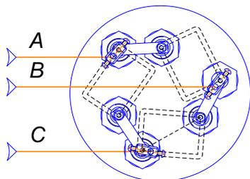
**Подключение секций мощностью 12, 18 кВт**
